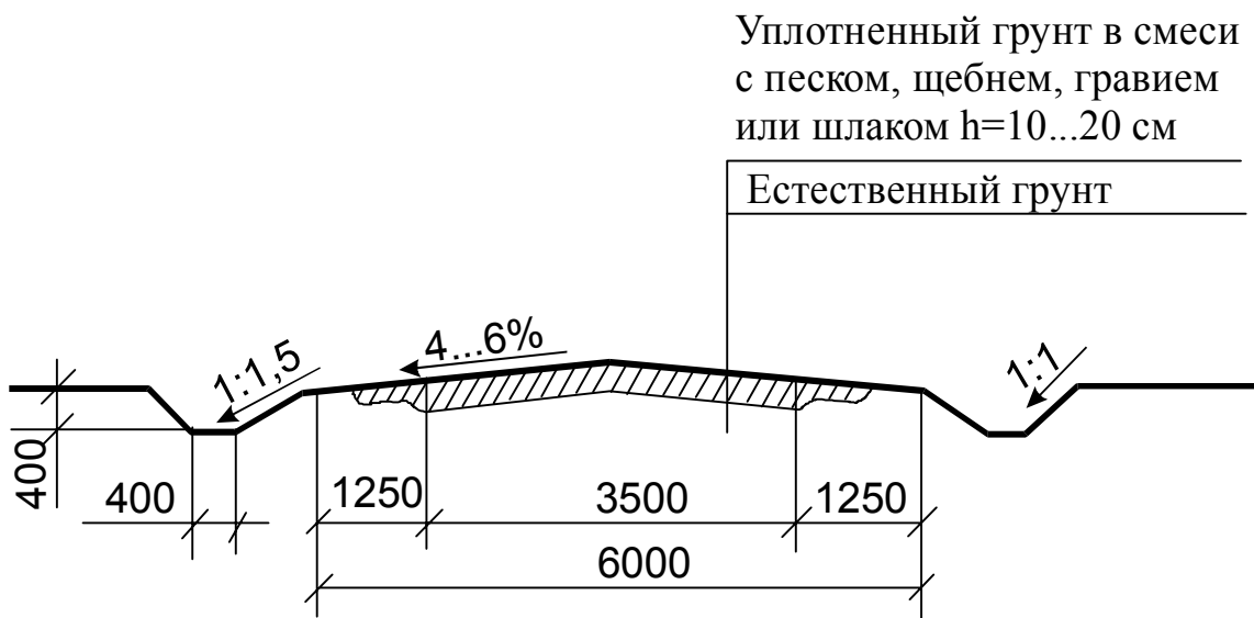
Рис. 3. Профиль временной грунтовой дороги с улучшенным покрытием
